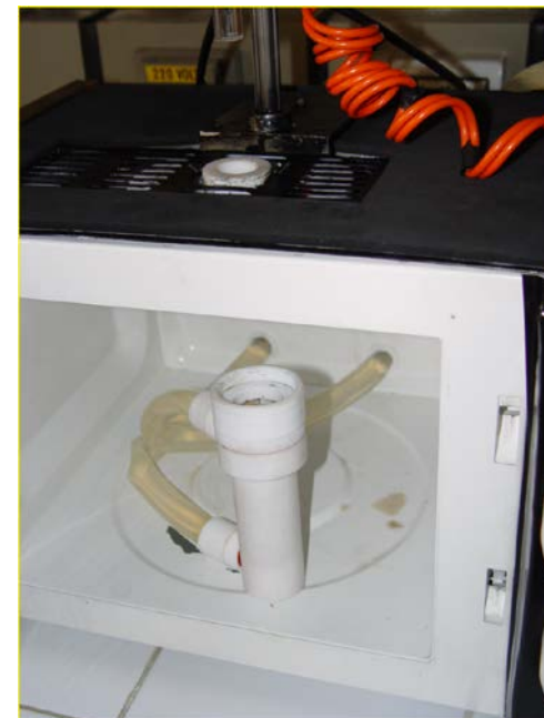
Лабораторний прототип реактора для одночасного опромінення (проф. Д. Кравотто)
