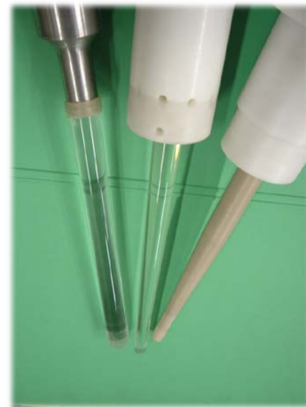
Різні типи радіопрозорих УЗ зондів (Кварц, Pyrex и РЕЕК)
