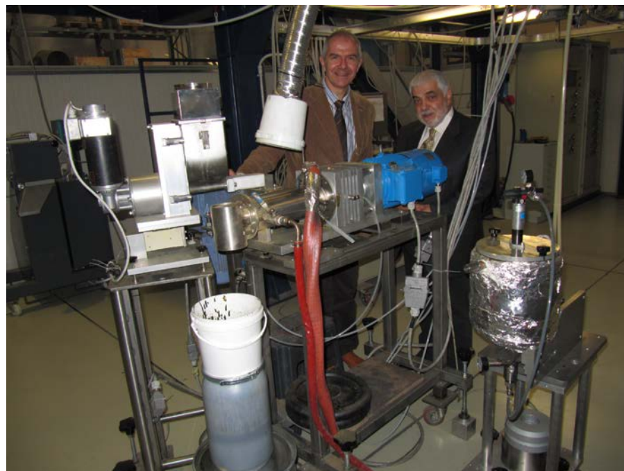
Проточні реактори на основі УЗ труби (реакція перебігає всередині труби)
