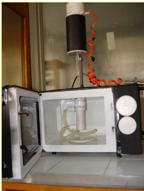
Лабораторний прототип реактора для одночасного опромінення (проф. Д. Кравотто)
